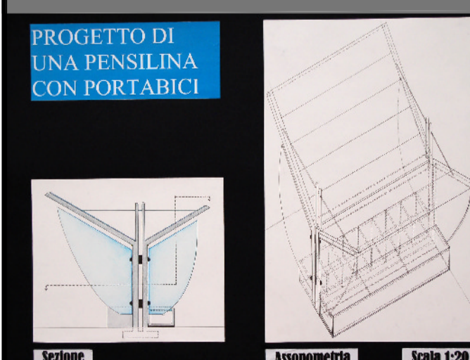
Autore: David Longeri Progetto: Pensilina fermata autobus o portabicci Nome: Prince Materiali: plexiglass, alluminio, vetro, legno Dimensioni: L150cm, H140
