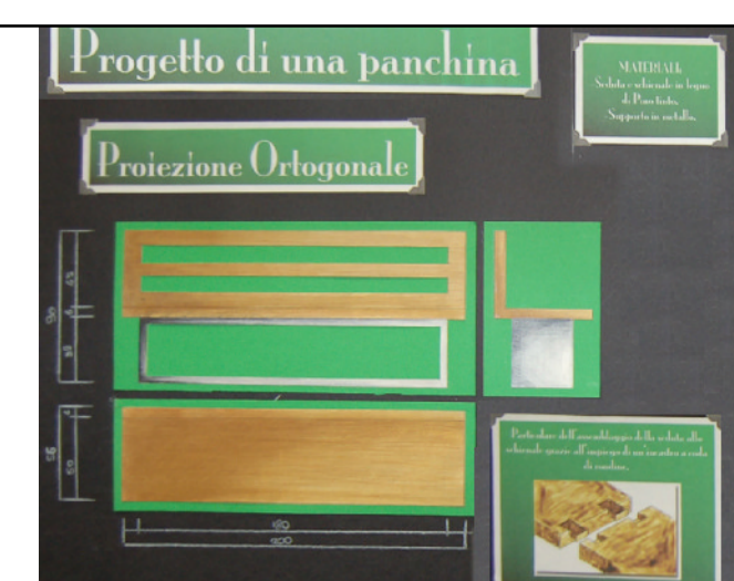
Autore: Melissa Madè 4Al Progetto d' arredo urbano: Panchina Nome: "Abygale" Materiali: Supporto in metallo, legno di pino tinto per la seduta e lo schienale. Dimensioni: Larghezza: 56cm, lunghezza: 200cm, h seduta: 45cm, h schienale: 90cm
